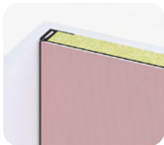
Chant non visible : baguette nue
