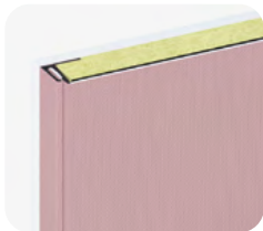
Chant visible : baguette gainée
